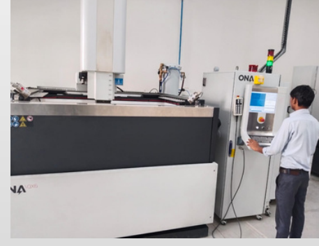
CNC DIE SINKER EDM MACHINES -02 NOS
